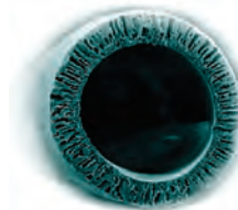
Sezione fibra cava Coupe transversale fibre creuse
